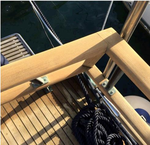
*Reprise des bouchons abimés ou manquants, nettoyage en profondeur et ponçage rapide au 40 puis au 60.*
